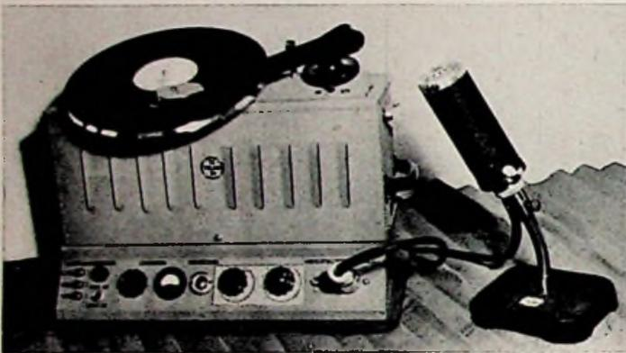
Abb. 1. Philips Autoübertragungsanlage für Batteriebetrieb, 6V, 20W
